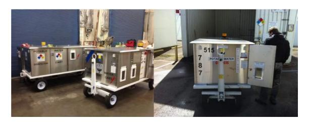
この写真は、世界各国に着陸した後に現地の飲料水をより安全・安心にするために 水質浄化をしたものをボーイング(BOEING)機の中に入れるために各空港に配備し ている写真です。
